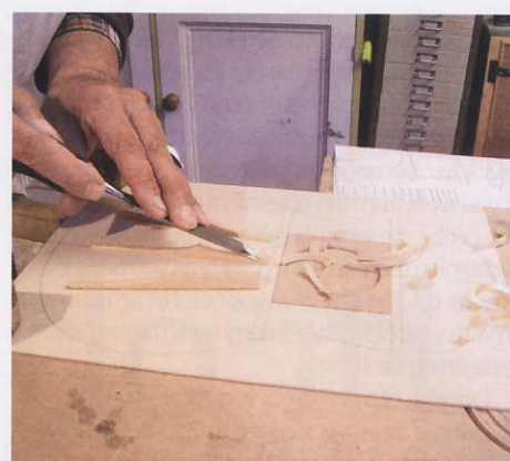
STEP 11. Scalloping the fan braces
