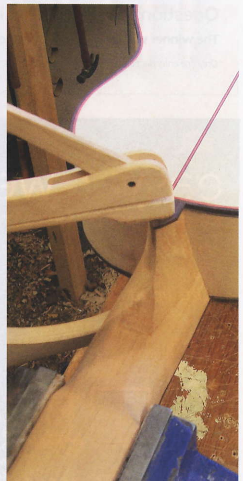
STEP 42. Fitting the heel cap
