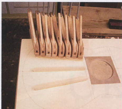
STEP 9. Clamping the fan bracing
